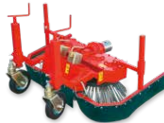
Spazzola per erbacce per l'eliminazione di erbacce su superfici stabili, larghezza di lavoro 90 cm
